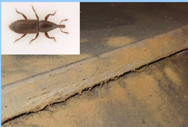
Abb. 2: Fraßgänge, Ausflügelöcher und Bohrmehl (gr. Bild) sowie Dorsalansicht des Käfers (kleines Bild)
